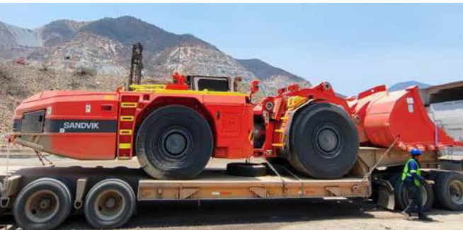
Entrega de un vehículo eléctrico a batería (BEV) para operaciones subterráneas en el Complejo Morelos
